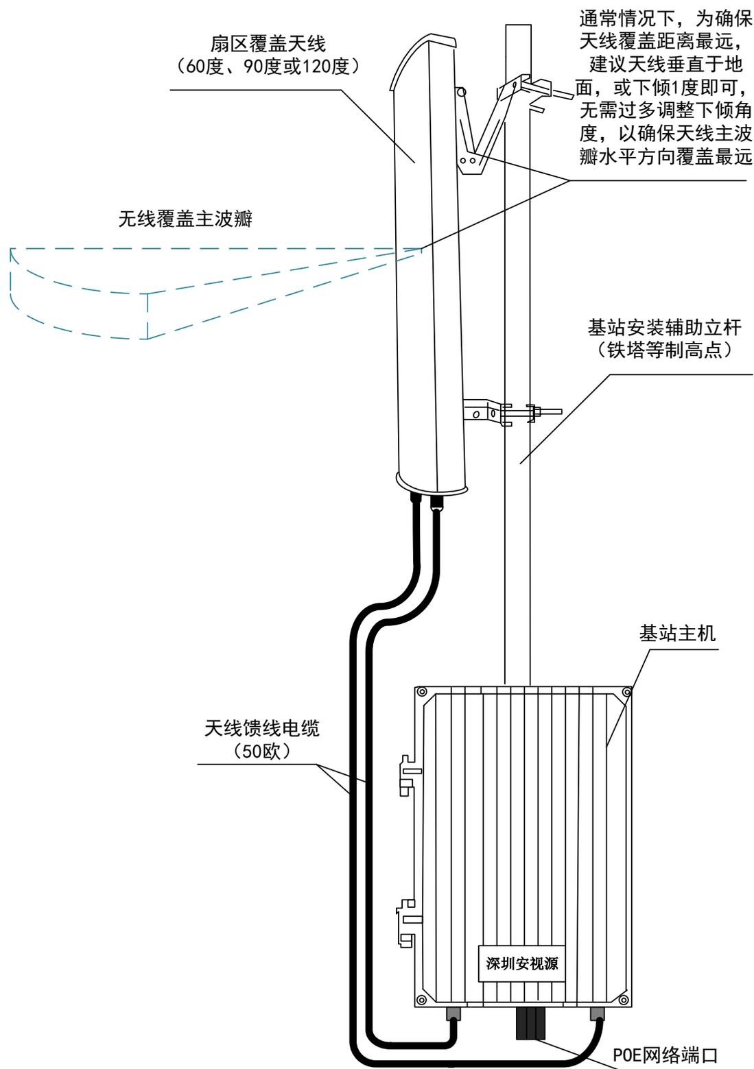
岸基基站主机和扇区天线，依据实际现场情况进行配置，根据现场情况，可能配置不同覆盖角度的天线。比如 30 度、60 度、90 度、120 度等覆盖角度天线，通常小角度覆盖天线，天线增益指标较高，距离更远，角度越大增益越小，覆盖距离相对稍近。对于实际应用项目可能需要配置多台主机和天线，或配置多个基站，来满足现场船只所航行区域的覆盖要求。设备户外安装完毕，天线馈线两端，务必通过防水自粘胶带以及 PVC 电工胶布多重包扎，以确保接头常年使用不会进水受潮，否则会因接头影响设备的长期性能。
