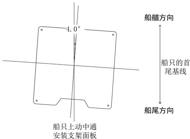
**cb** 设置设备船尾方向与船只实际船尾夹角, 安装后设备头如果对船头往左, 则设置负值, 如果设备头偏向对船头往右, 则设置正值。设置值, 支持一位小数点。
