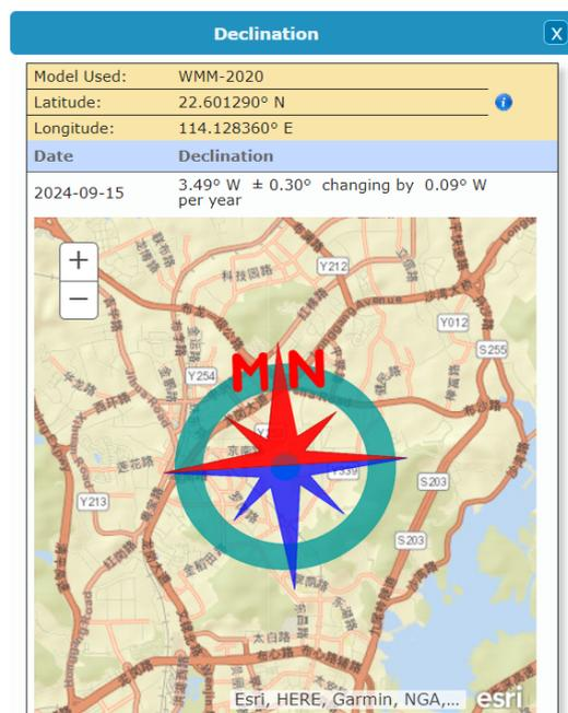
如果使用地磁偏角为北偏西 8.2 度, 则设置 co 值为:  $8.2-3.5=4.7$ 。输入 co4.7 即可。直接输入 co 则查询并显示当前已设置的偏移量(注:本系统磁偏角设置精度 0.5 度)。此参数仅对所有工作模式都起作用。
